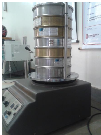
Figura 2. Aparelho agitador de peneiras modelo Bertel – vibração 8.
