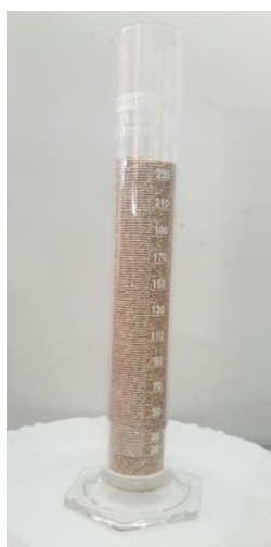
Figura 4. Análise de densidade através de deslocamento de sementes de painço.
