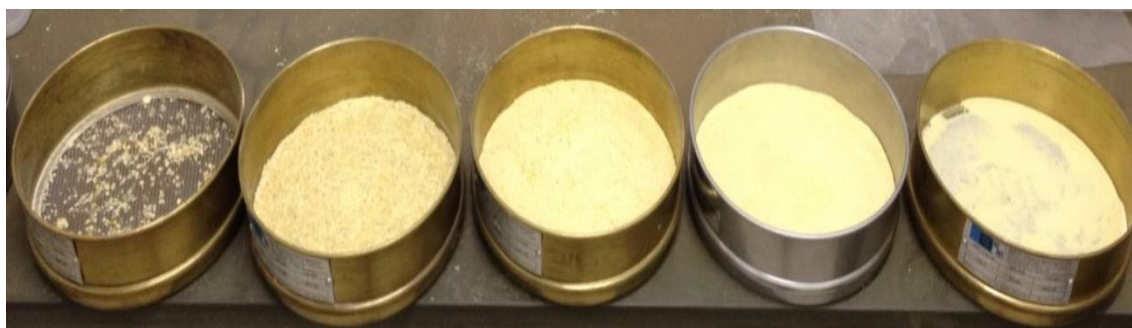
Figura 3. Farelo de milho após a separação em peneiras, frações 2,0, 1,0, 0,5, 0,250 e 0,125 mm.
